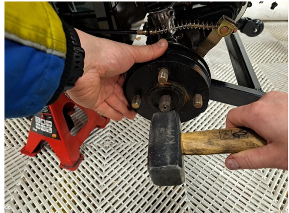
Vedä takapyörän napaa ja samalla napauta kevyesti vasaralla taka-akseliin, että takapyörän napa irtoaa.
